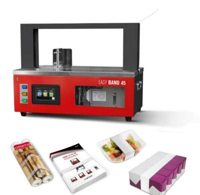
**Utilizzo:** Selezionando la modalità automatica, basta appoggiare il prodotto sul piano della fascettatrice. Una fotocellula, leggendo il prodotto, avvia il ciclo di fascettatura e saldatura. Rimuovendo il prodotto la macchina effettua il rilancio, preparandosi alla fascettatura successiva. Selezionando il ciclo manuale, l'operatore avvia la fascettatura manualmente tramite pulsante. La sostituzione del rotolo di fascetta è veloce e semplice.
